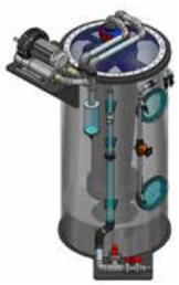
Abb. 1: Schemazeichnung eines Denitrifikationsreaktors
